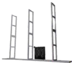
Шаг 2: Присоедините панели экрана к раме с помощью соединительных блоков
